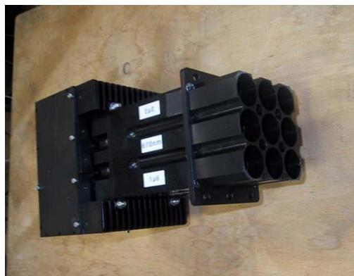
Fig. V.8 : Tête optique avec les 9 cavités optiques de MiniMIR.
