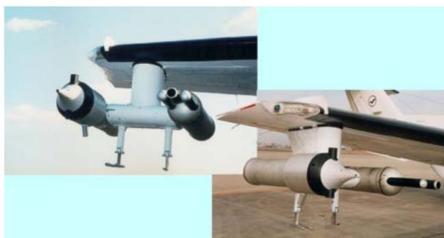
*Fig. V.12 : Intégration de la sonde 2D-C et du néphélogmètre polaire sous l'aile d'un avion de mesure. La sonde 2D-C est à droite sur les images et le néphélogmètre à gauche.*
