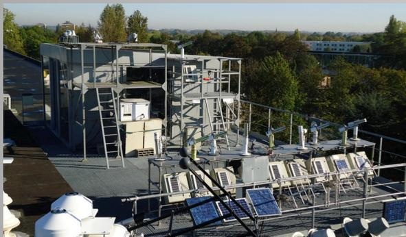
L'Observatoire atmosphérique situé sur le toit du LOA à Villeneuve d'Ascq comprend un panel d'instruments de télédétection dédiés à l'étude de l'atmosphère (photomètre, lidar, radiomètres et spectroradiomètres).
