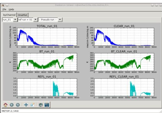
Ici un exemple de fenêtre radiance après un run de RTTOV pour l'instrument IASI sur un profil atmosphérique. L'utilisateur a ici choisi l'option ADDSOLAR et dans ce cas RTTOV GUI affiche les réflectances simulées par RTTOV pour les différents canaux de IASI.
