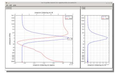
Dans cet exemple, l'utilisateur a travaillé uniquement avec le canal 14 du AMSU-A de metop-01. Le canal 14 est un canal « stratosphérique » à 57.290 Ghz. Son apport est principalement observé à 1hPa : On observe bien que pour le profil reconstitué de températures (en rouge), les valeurs de températures s'approchent des valeurs du profil « True ».
