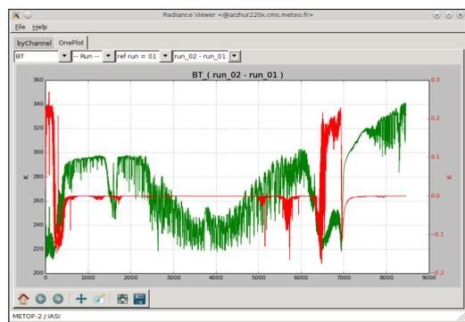
Dans ce deuxième run avec le même profil, l'utilisateur a choisi d'ajouter la prise en compte du CO2 contenu dans son profil atmosphérique : La courbe en rouge (différences de températures de brillance entre le run 2 et le run 1) montre l'effet sur le spectre IASI de l'utilisation d'un profil de CO2 réel par rapport à un profil de CO2 par défaut.
