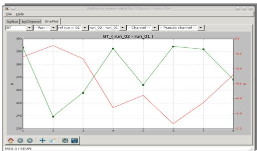
La fenêtre Radiance permet de visualiser les radiances et les températures de brillance simulées par RTTOV. Dans cet exemple la différence entre 2 runs de RTTOV est affichée : La courbe verte correspond au premier run (sans les aérosols, la courbe rouge indique les différences de températures de brillance quand RTTOV prend en compte les aérosols VOLA (cendres volcaniques) : on observe une baisse de plus de 1 degré pour le canal 6 à 10.6 µm de MSG3.
