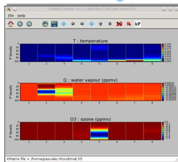
La fenêtre K profile permet de visualiser les profils verticaux du jacobien du modèle direct pour un canal donné.
